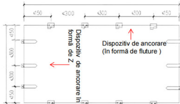
Diagrama de instalare a ancorei
